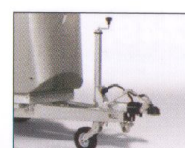
Autom. Stützrad, verlängert, Laufrad klappt beim Hochkurbeln automatisch ein
