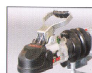
Abschließbare Gusskupplung mit ummanteltem Komfortgriff und Soft-Top (Anfahrerschutz)
